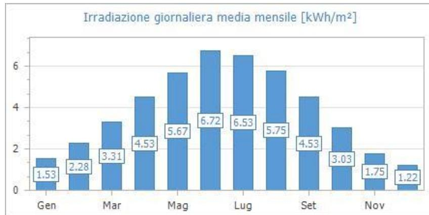
Fig. 1: Irradiazione giornaliera media mensile sul piano orizzontale [kWh/m²]- Fonte dati: UNI 10349:2016 - Stazione di rilevazione: Frosinone
