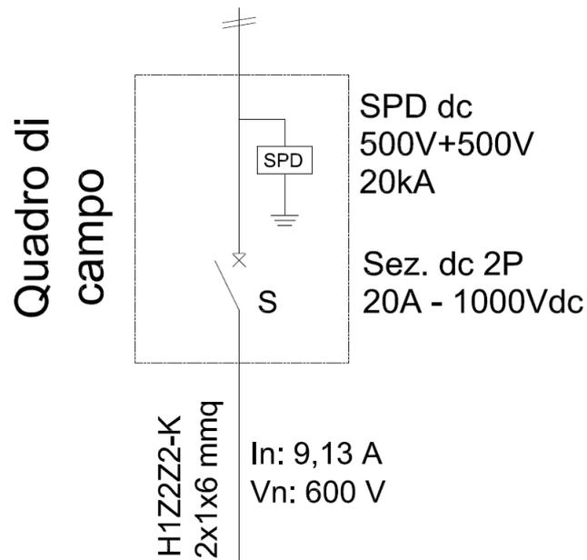
Fig. 6: Schema unifilare quadro "Quadro di campo 1 e 2"
