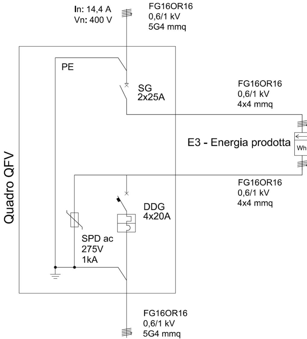
Fig. 5: Schema unifilare quadro "Quadro QFV"
