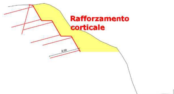
Figura 14 Esempio di rafforzamento corticale con rete e chiodi autoperforanti presso la ZONA NORD
