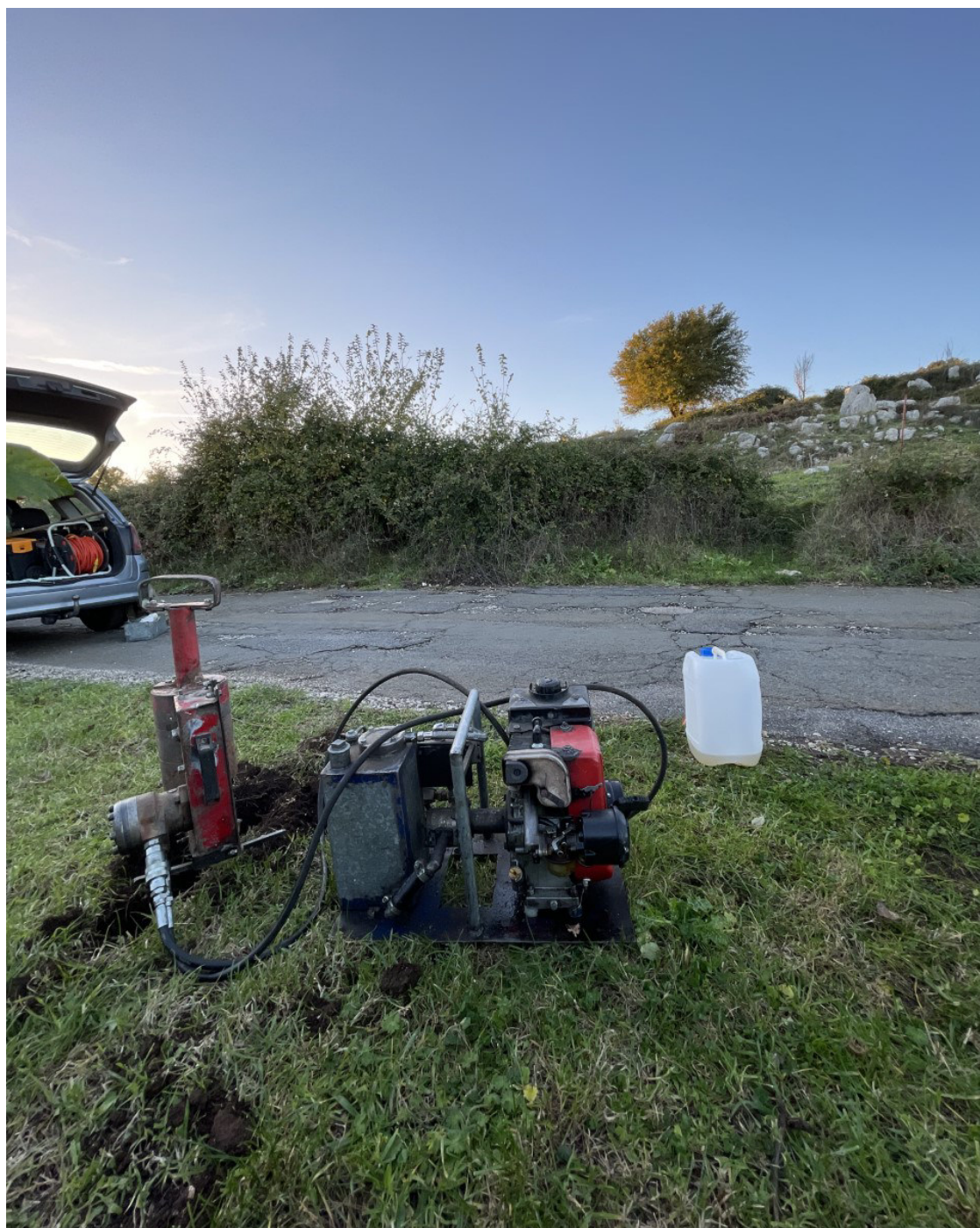
Esecuzione Prova Penetrometrica Dinamica – DPM 2
