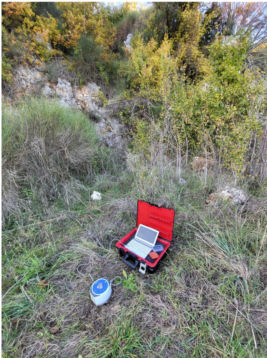
Acquisizione Sismica passiva HVSR
