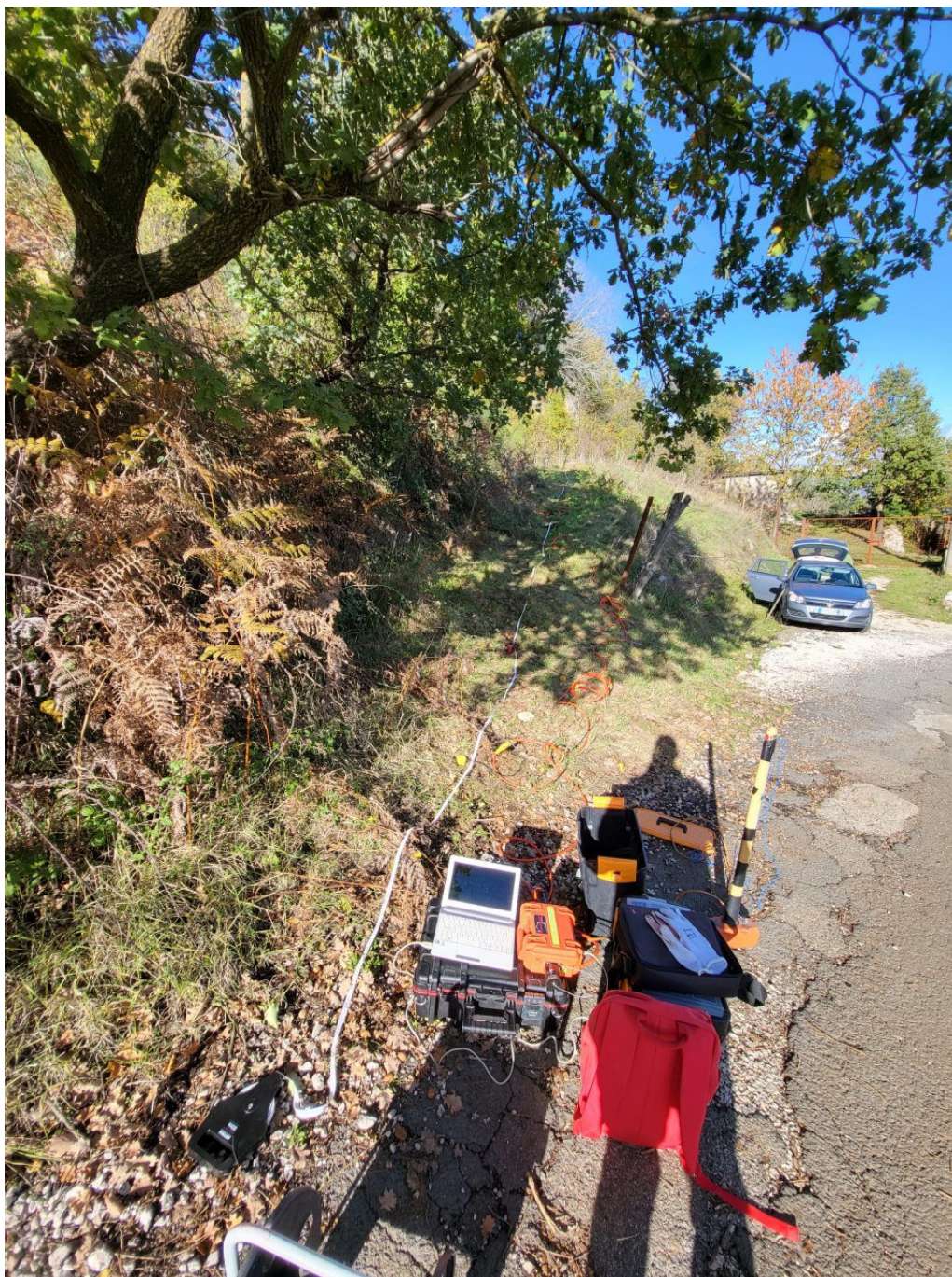
Stendimento ed esecuzione prova sismica MASW 2 – porzione alla base dell'affioramento roccioso
