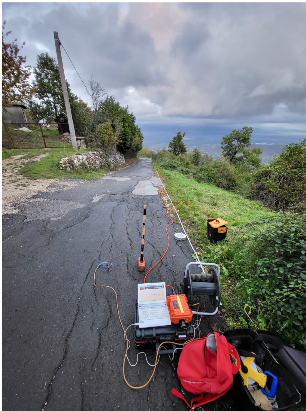
Stendimento ed esecuzione prova sismica MASW 1 – porzione lungo strada
