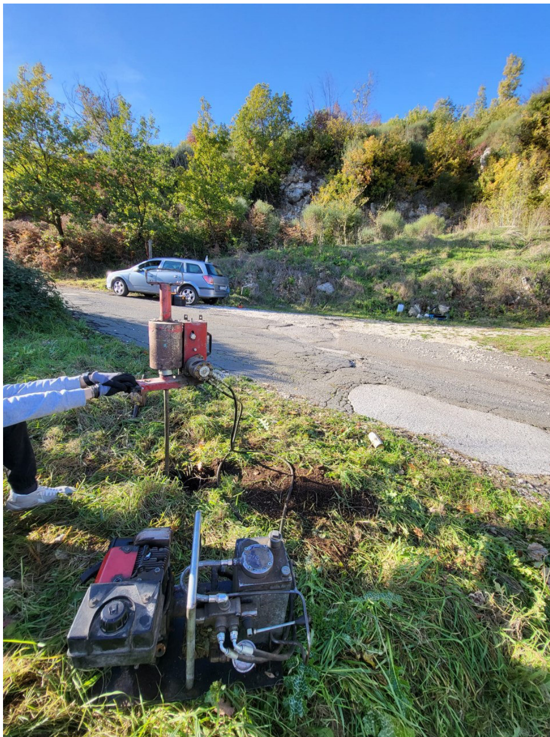
Esecuzione Prova Penetrometrica Dinamica – DPM 1
