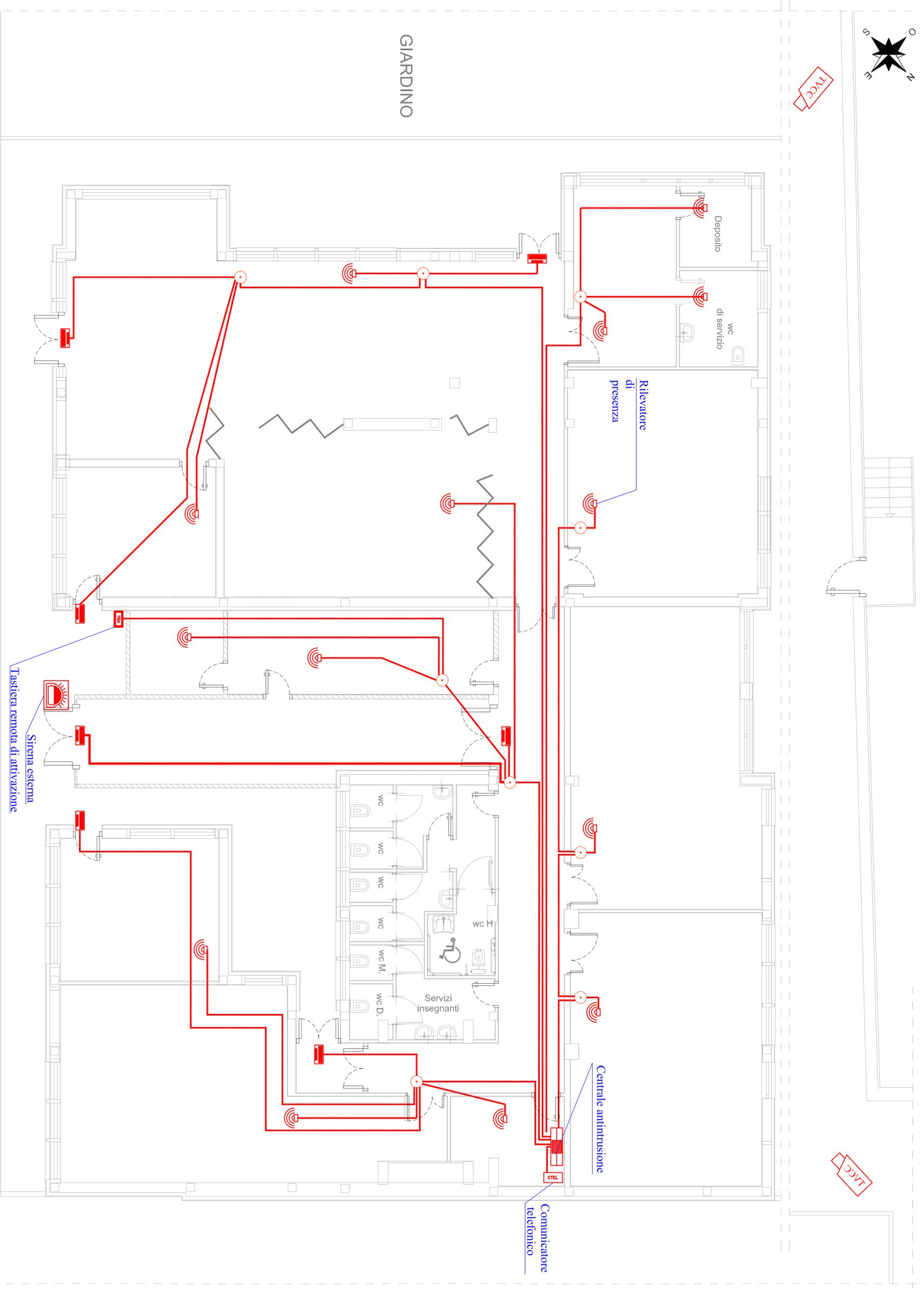
PIANTA IMPIANTO ANTINTRUSIONE - Scala 1:50
