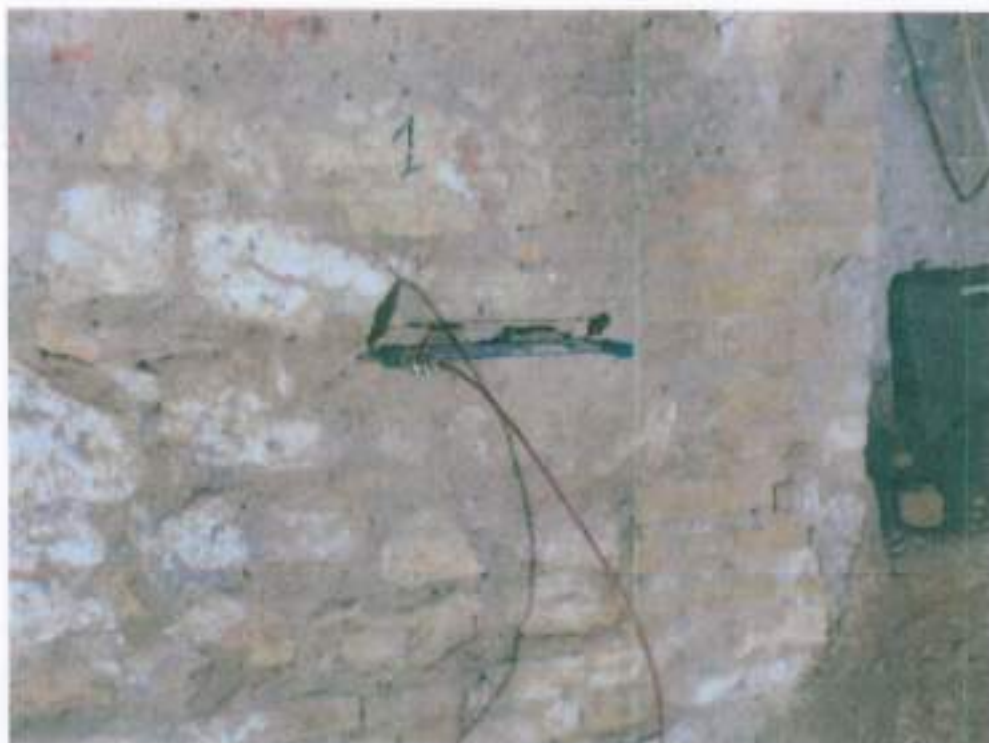
Prova n° 1 (Martinetto piatto singolo)
