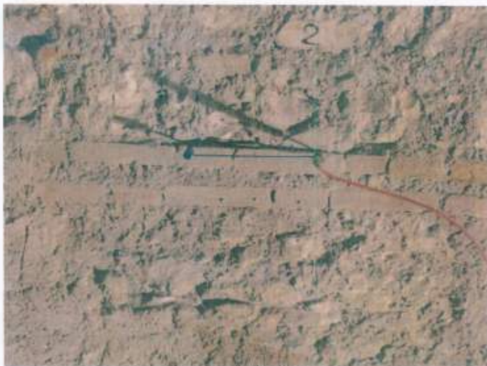
Prova n° 2 (Martinetto piatto singolo)
