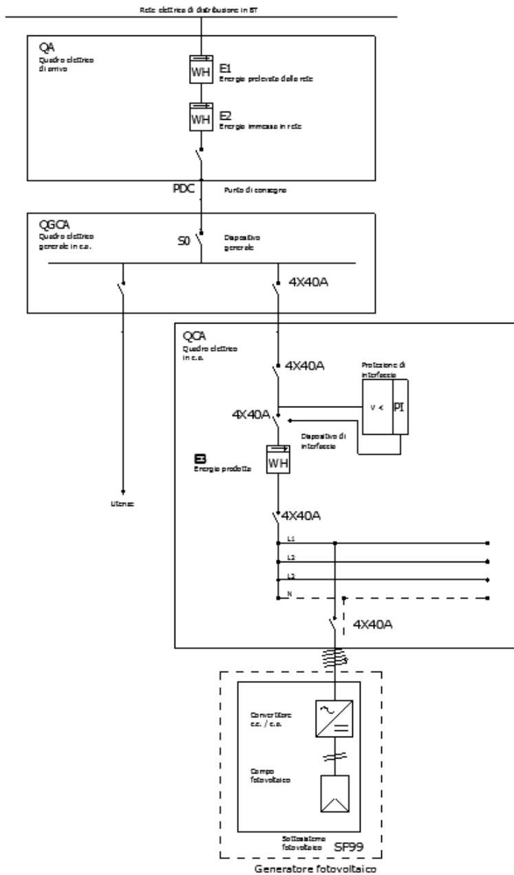
Fig. 4: Schema elettrico unifilare dell'impianto
