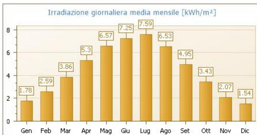
Fig. 1: Irradiazione giornaliera media mensile sul piano orizzontale [ kWh/m<sup>2</sup> ] - Fonte dati: UNI 10349
