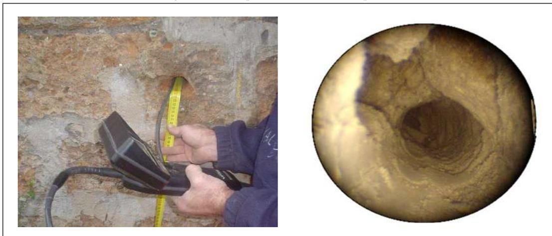
Le prospezioni videoendoscopiche, che consistono nell'eseguire un'ispezione visiva all'interno di un foro appositamente praticato nell'elemento da investigare, rilevandone le variazioni stratigrafiche, sono state effettuate con la seguente procedura:
