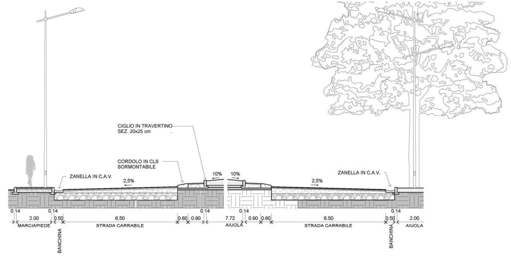
SEZIONE TIPO ROTATORIA
