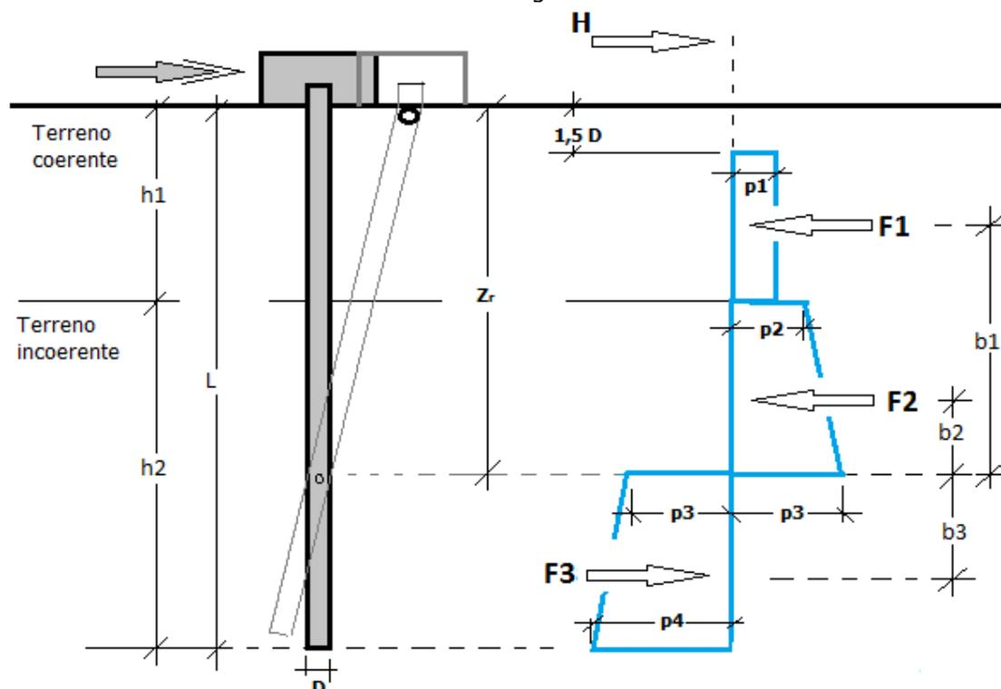
Nella fase di calcolo, si verifica se il meccanismo di rottura del palo, ipotizzato vincolato in testa (rotazione alla testa impedita) sia di:
