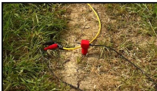
**Fig. 3:** Geofoni verticali da 4,5 Hz
