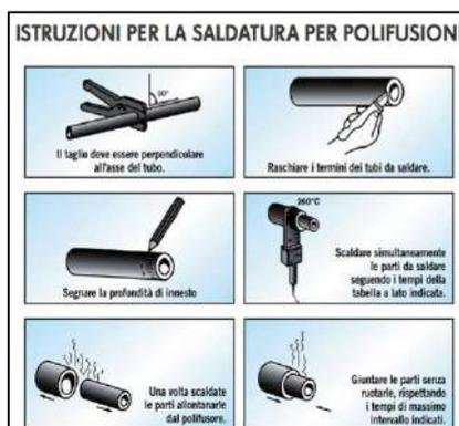
Saldatura di tubazione in polipropilene
