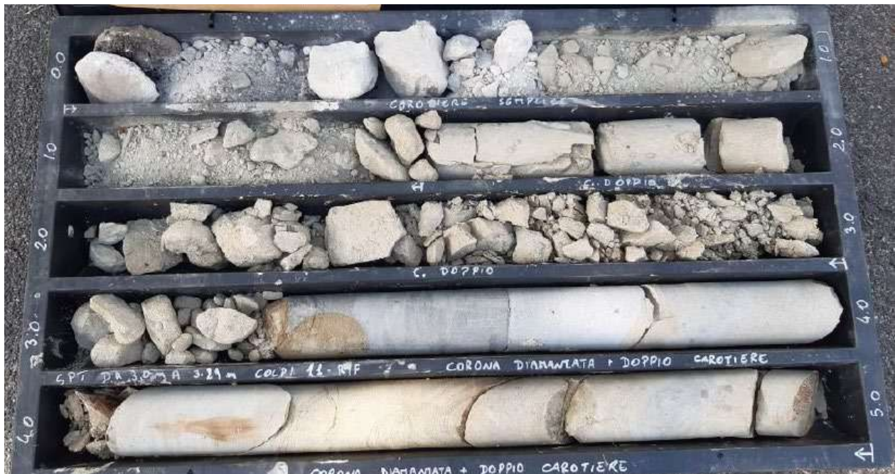
Foto 17 – Sondaggio S1dh (Via Papa Braschi) – Terreni di riporto di spessore 1.5 m seguiti inferiormente da arenarie molto fratturate fino a -3.30 m. A maggiore profondità arenarie massicce poco fratturate
