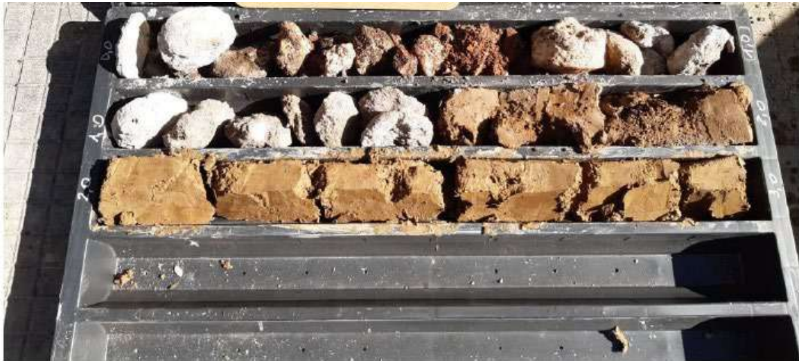
Foto 27 – Scuola elementare (Corpo A) – Carotaggio inclinato effettuato in fondazione SF4 e descrizione stratigrafica
