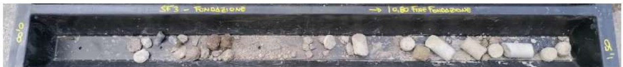
Foto 25 – Scuola elementare (Corpo A) – Carotaggio inclinato effettuato in fondazione SF2 e descrizione stratigrafica
