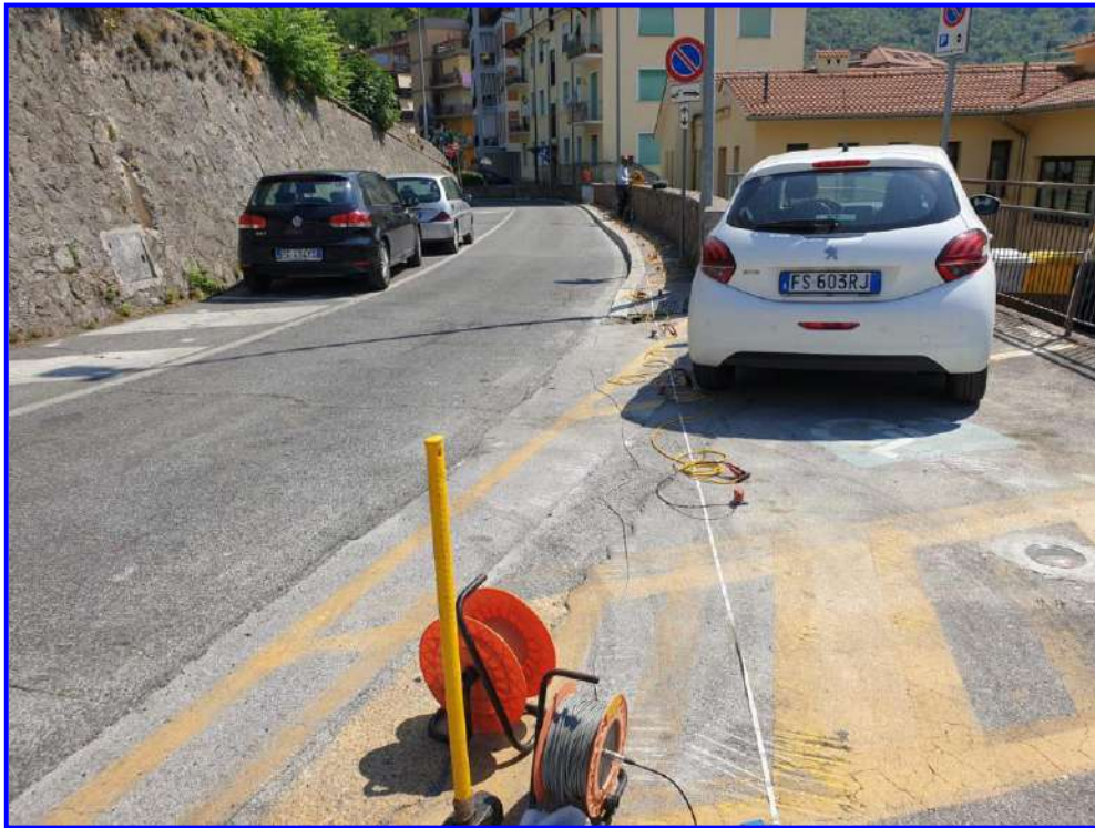
Prospezione di sismica a rifrazione / MASW n.1
