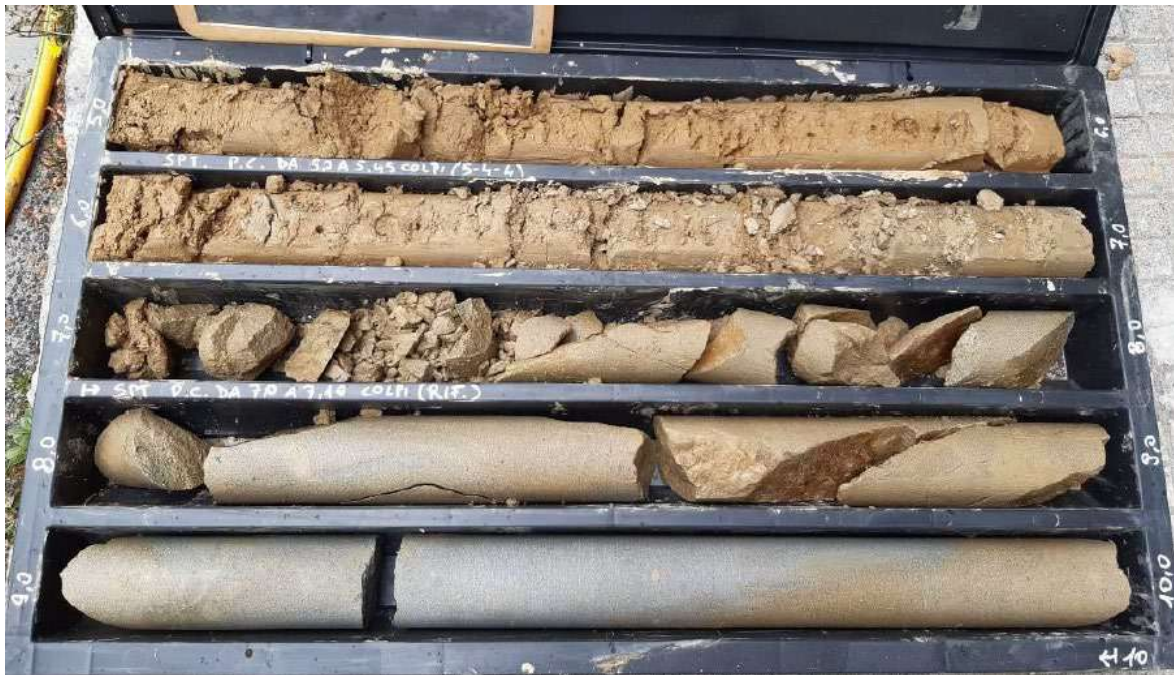
Foto 20 – Sondaggio S04 – Depositi limosi e limoso-sabbiosi passanti inferiormente ad arenarie litoidi in corrispondenza del piede del versante, presso via Metastasio
