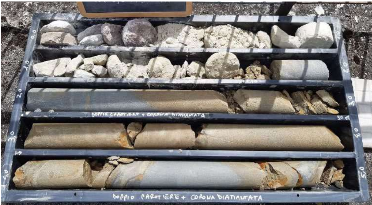
Foto 16 – Sondaggio S2p (Via A.Fogazzaro) – Arenarie massive da poco a mediamente fratturate sottostanti a circa 1.7 m di terreni di riporto e materiale detritico di copertura
