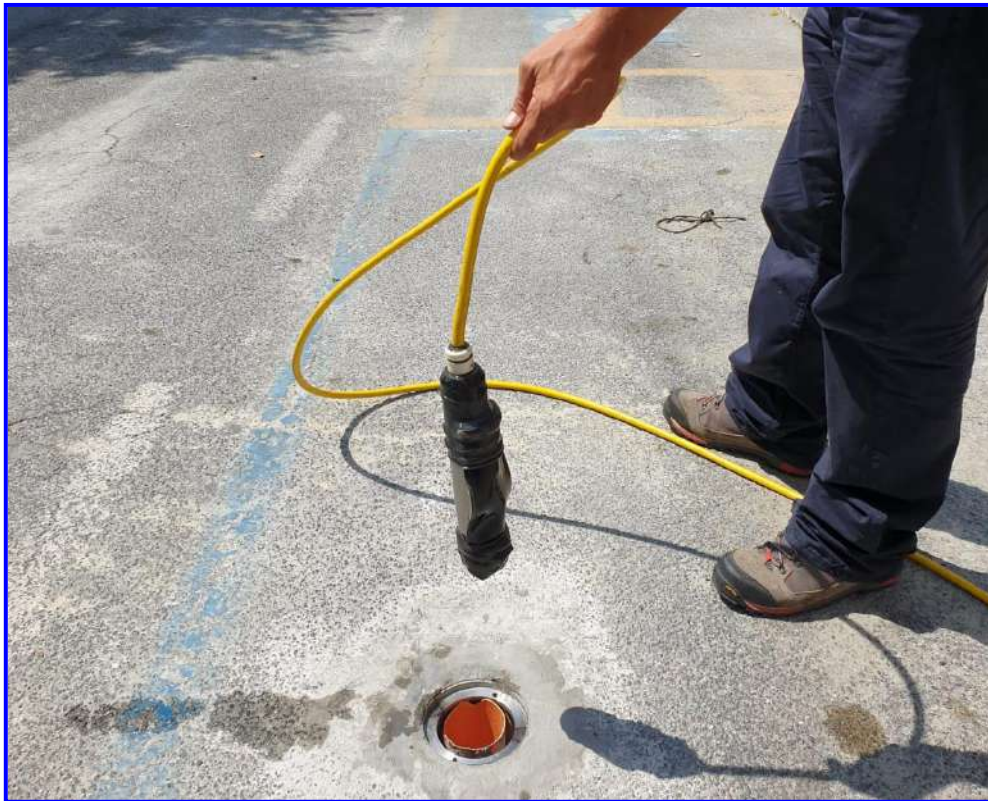
Sonda geofonica da foro a tre componenti (3 geofoni Geospace a 4.5Hz).
