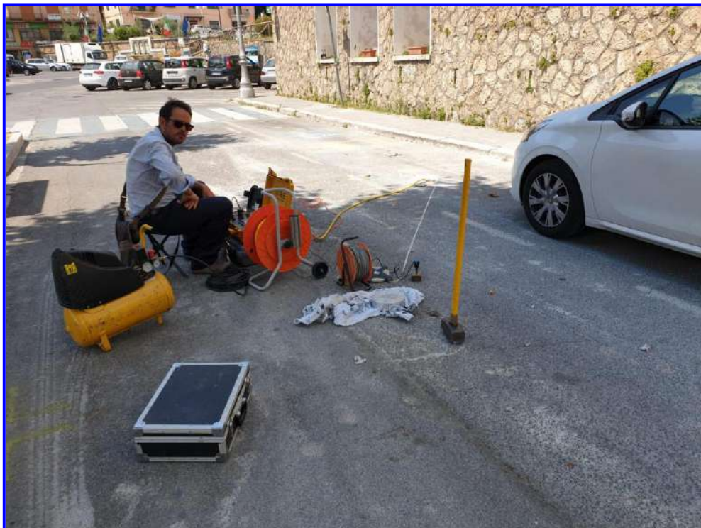
Prospezione sismica Down-Hole n.1
