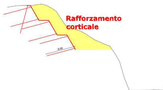
Figura 13 - Esempio di rafforzamento corticale con rete e chiodi autopercuotenti
