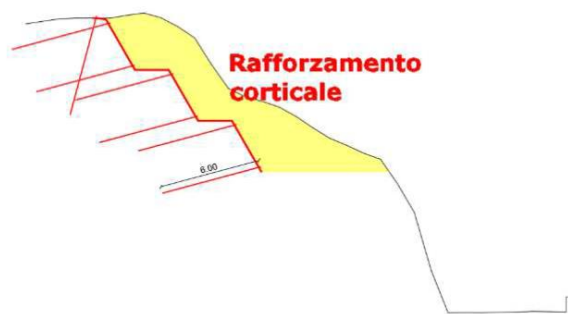
Figura 14 Esempio di rafforzamento corticale con rete e chiodi autoperforanti presso la ZONA NORD (sinistra)
