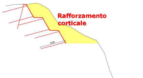
Figura 12 - Esempio di rafforzamento corticale con rete e chiodi autoperforanti presso la ZONA NORD
