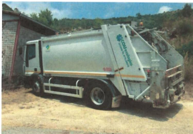
Figura 14: esempio di mezzo compattatore
