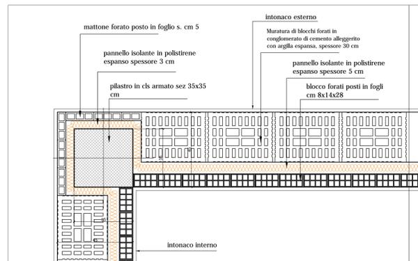
**DETTAGLIO 2 - SEZIONE VERTICALE DELL'EDIFICIO scala 1:10**
