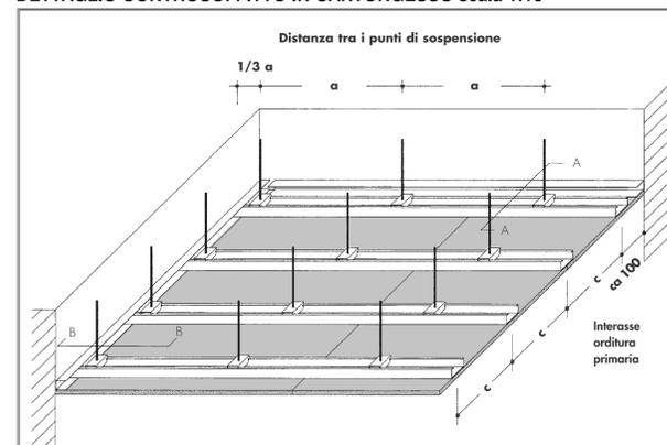
Controsoffitto realizzato con lastre di cartongesso, fissate mediante viti autopercoranti ad una struttura costituita da profilati in lamiera di acciaio zincato dello spessore di 6/10 mm ad interasse di 600 mm, comprese la stessa struttura e la stuccatura dei giunti
