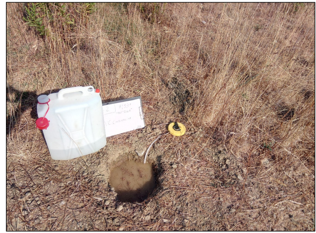
Foto 12: Fasi di svolgimento della prova di assorbimento in sito "a carico variabile" (Pp2), Norme A.G.I.
