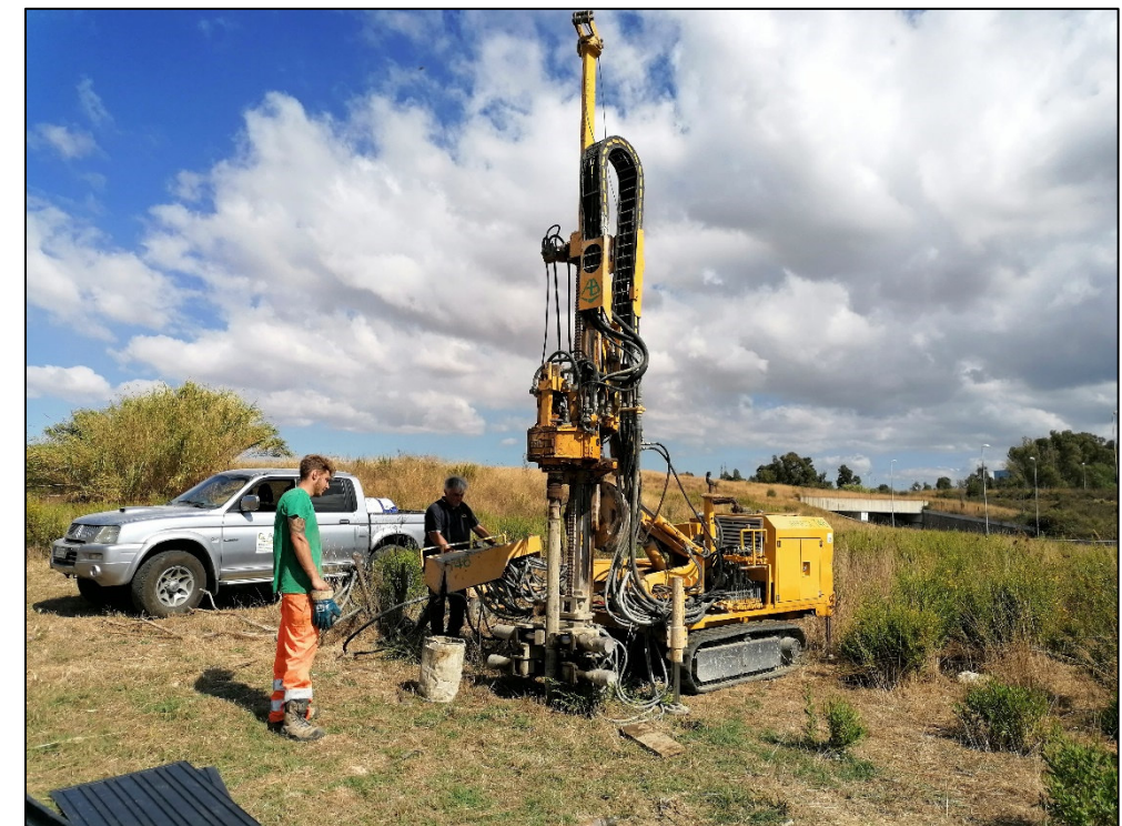
Foto 6: Sondaggio S2 fase di perforazione in carotaggio continuo \phi = 101 mm, carotiere semplice. Sonda Beretta T46 cingolata.
