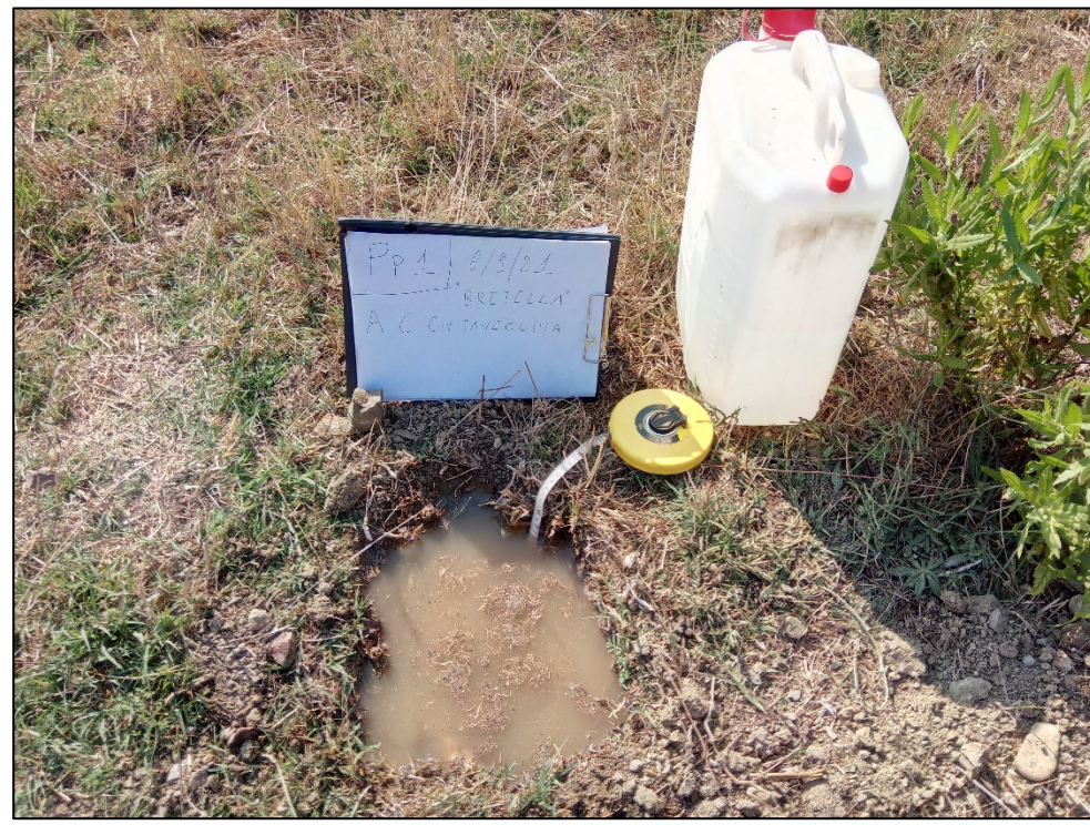
Foto 11: Fasi di svolgimento della prova di assorbimento in sito "a carico variabile" (Pp1), Norme A.G.I.
