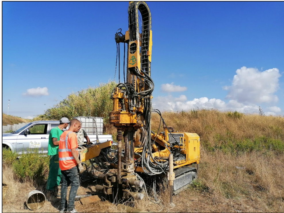
Foto 1: Sondaggio S1 fase di perforazione in carotaggio continuo \phi = 101 mm, carotiere semplice. Sonda Beretta T46 cingolata.
