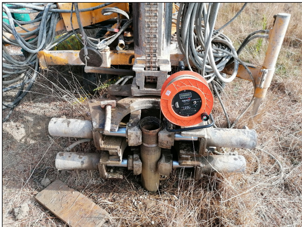
Foto 4: Prova Lefranc S1_L1; profondità da p.c. -1,50 m
