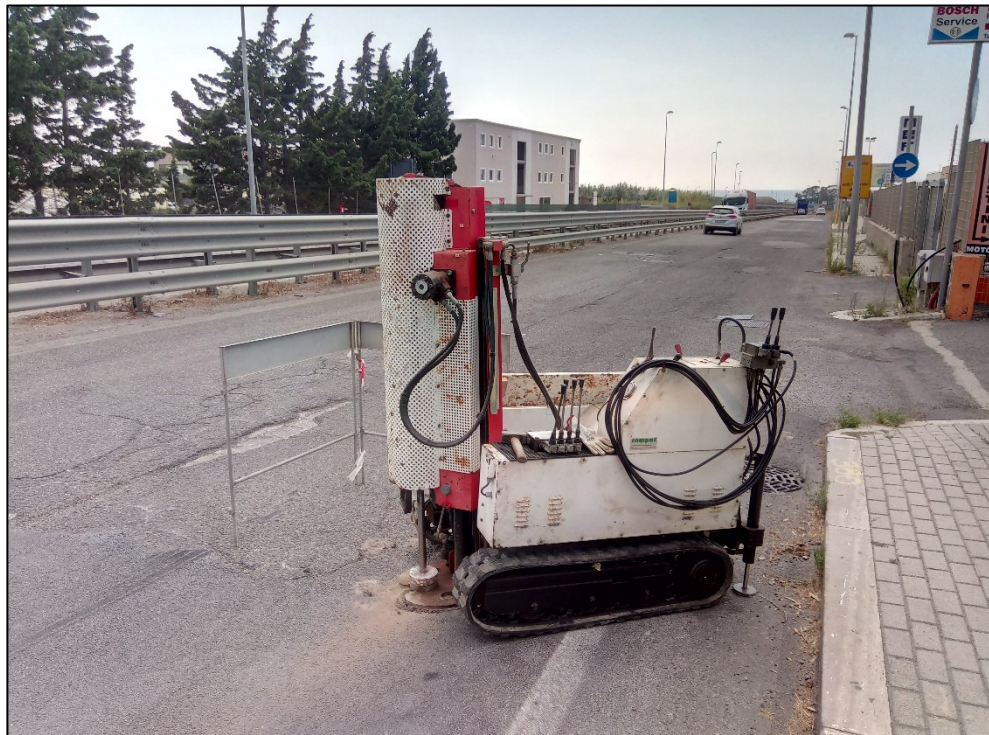
Foto 28: Prova penetrometrica dinamica superpesante DPSH (Pnt_13)
