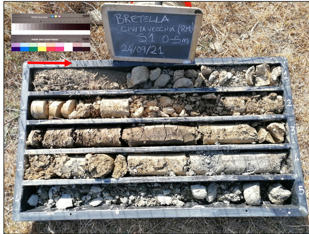
Foto 2: Cassetta catalogatrice S1; profondità da p.c. da 0 a -5 m
