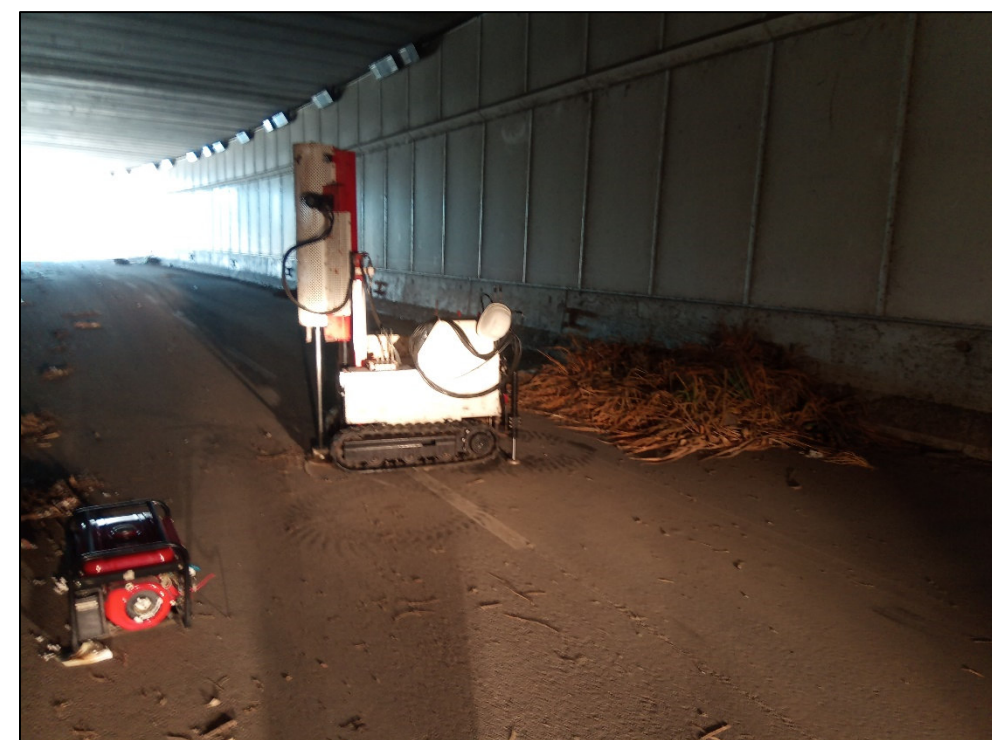
Foto 24: Prova penetrometrica dinamica superpesante DPSH (Pnt_9)
