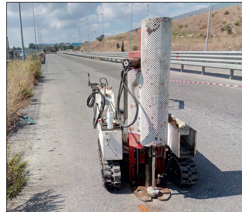
Foto 21: Prova penetrometrica dinamica superpesante DPSH (Pnt_6)
