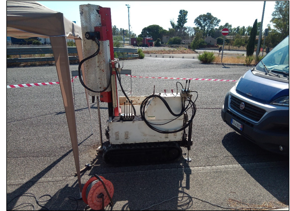
Foto 27: Prova penetrometrica dinamica superpesante DPSH (Pnt_12)
