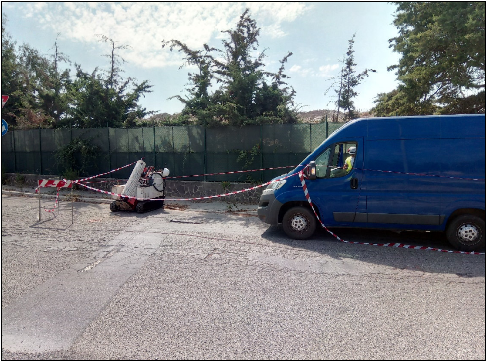
Foto 17: Prova penetrometrica dinamica superpesante DPSH (Pnt_2).
