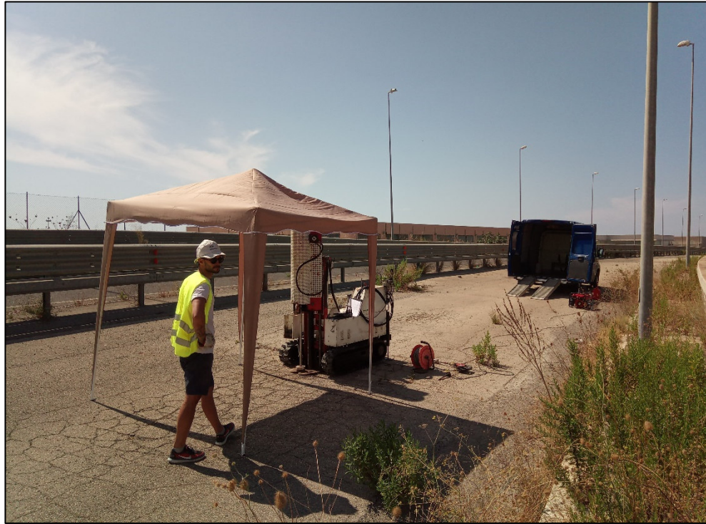
Foto 25: Prova penetrometrica dinamica superpesante DPSH (Pnt_10)
