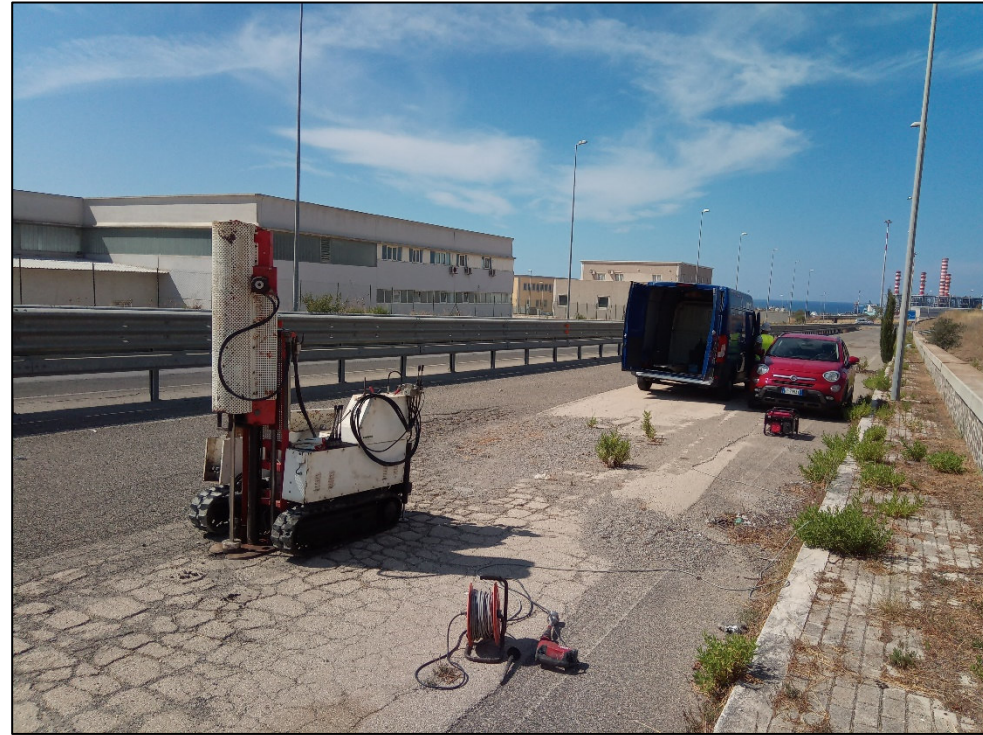
Foto 26: Prova penetrometrica dinamica superpesante DPSH (Pnt_11)
