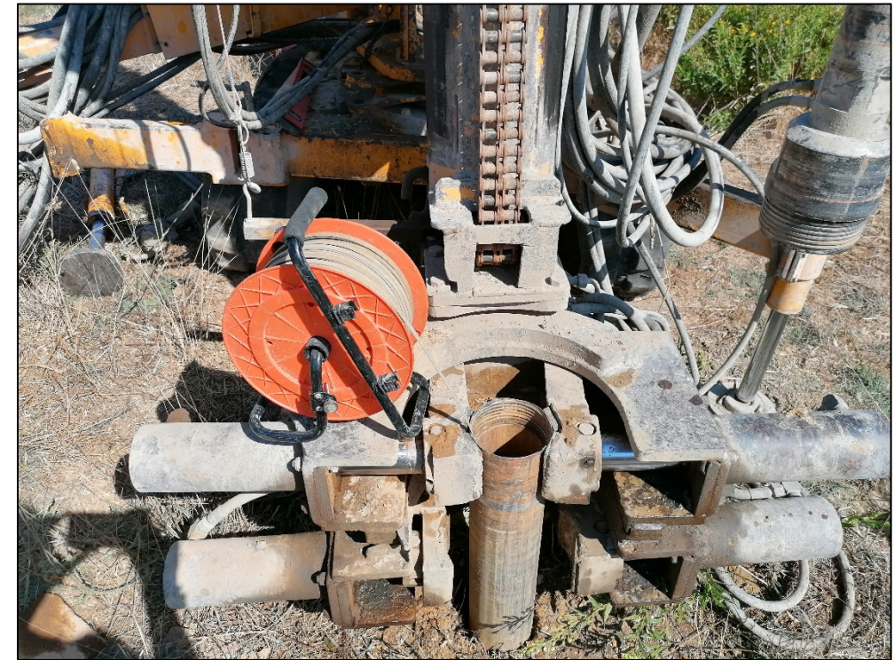
Foto 9: Prova Lefranc S2_L1; profondità da p.c. -1,50 m
