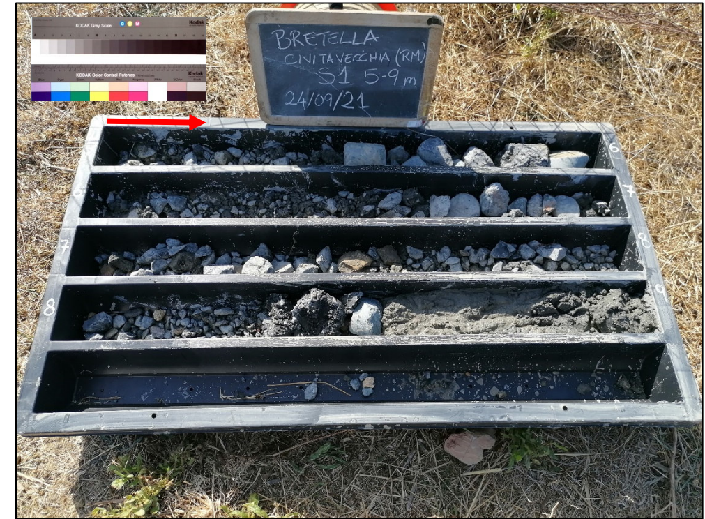
Foto 3: Cassetta catalogatrice S1; profondità da p.c. da -5 a -9 m
