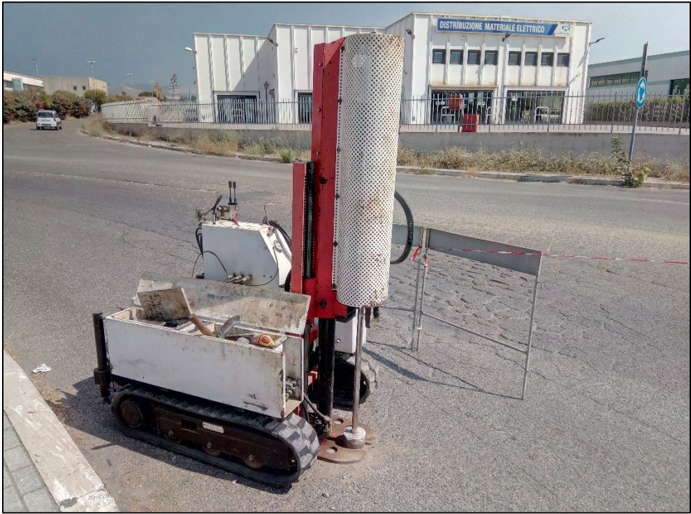
Foto 18: Prova penetrometrica dinamica superpesante DPSH (Pnt_3)
