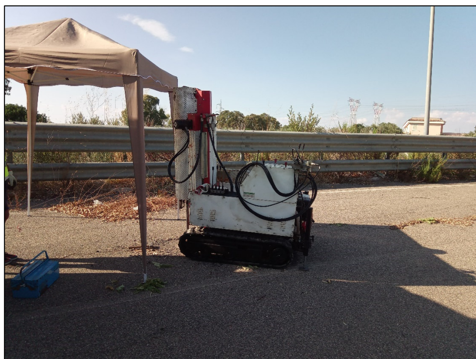
Foto 23: Prova penetrometrica dinamica superpesante DPSH (Pnt_8)
