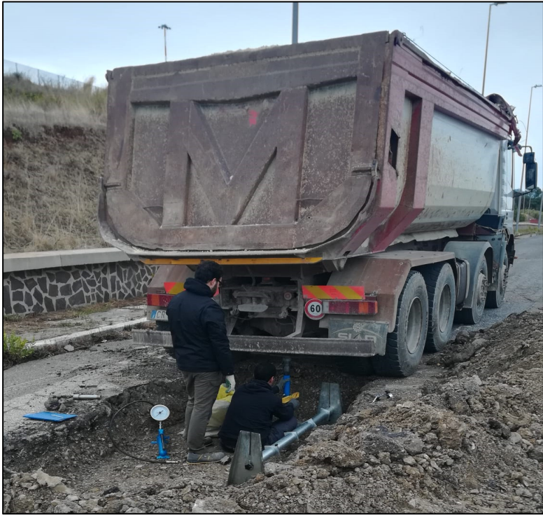
Foto 14: Prova di carico su piastra
