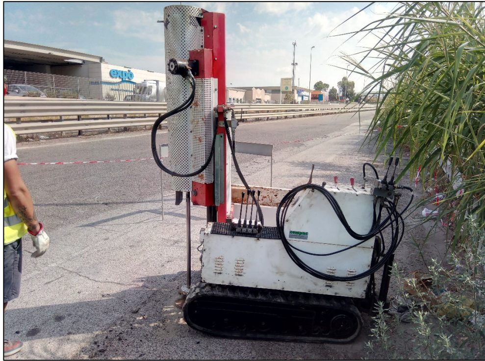
Foto 16: Prova penetrometrica dinamica superpesante DPSH (Pnt_1)
