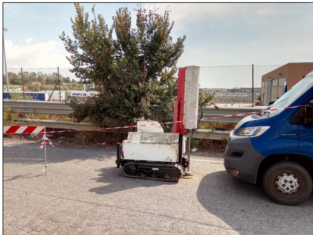
Foto 20: Prova penetrometrica dinamica superpesante DPSH (Pnt_5)
