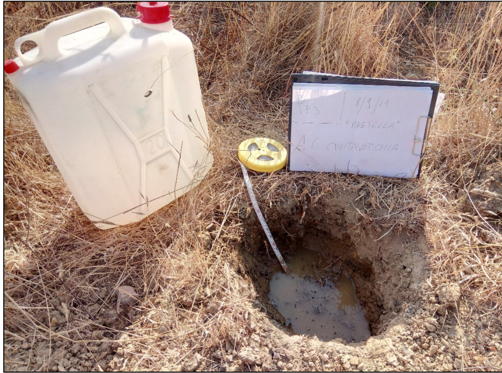
Foto 13: Fasi di svolgimento della prova di assorbimento in sito “a carico variabile” (Pp3), Norme A.G.I.
