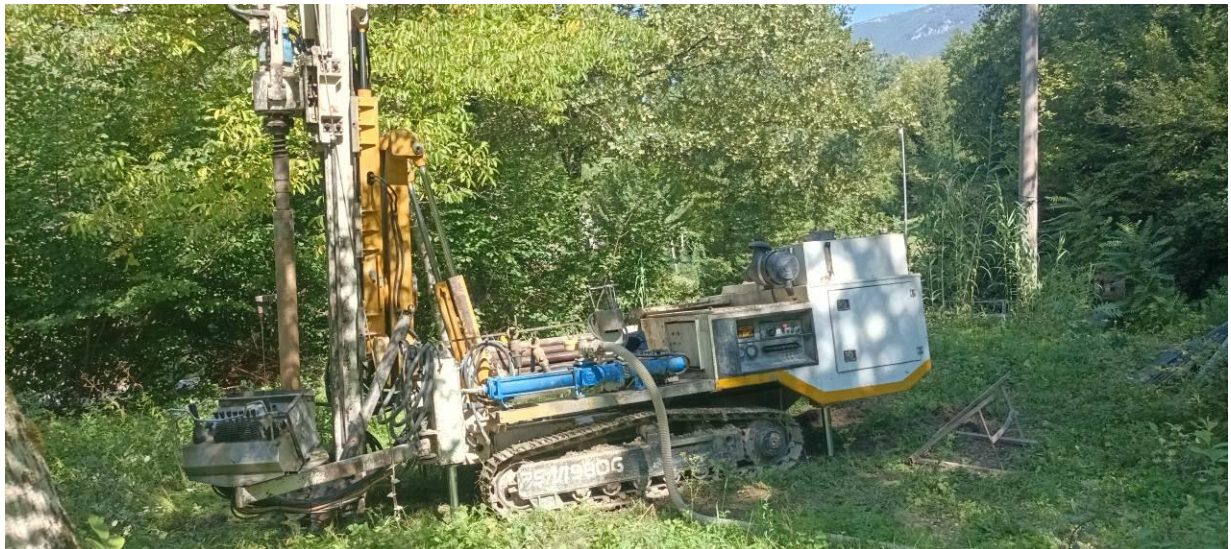
Fig. 1 - Perforatrice idraulica PSM 980 G
