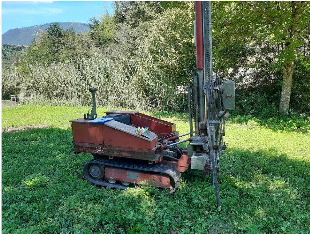
Fig. 5 - Penetrometro autoancorante TG 63/200 kN
