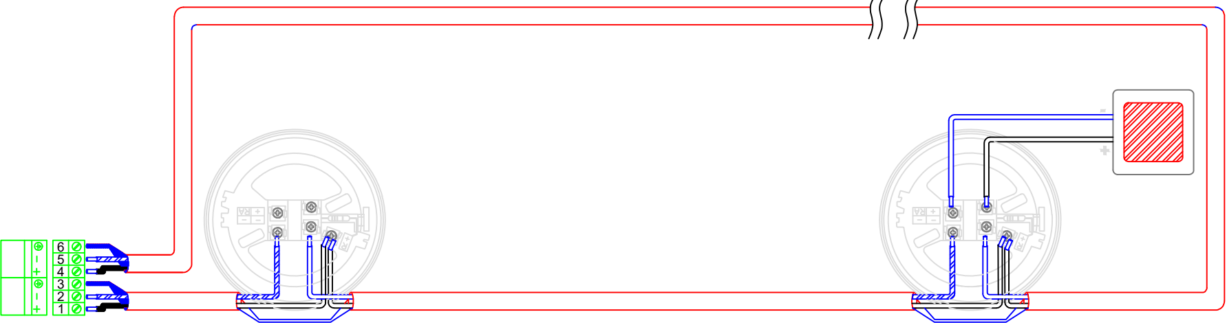
RILEVATORI DI FUMO MONTATO IN CONTROSOFFITTO CON GEMMA DI SEGNALAZIONE ESTERNA
